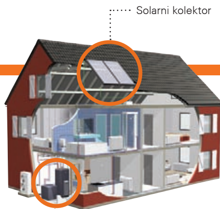
Notranja enota in hišni rezervoar za toplo vodo
